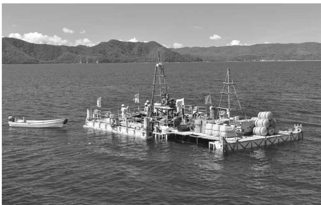
猪苗代湖湖底堆積物の掘削台船。最深部に近い水深 90m 地点で、約 30m のコア試料を 2 本掘削した。本年 12 月に福島大学で行う古気候変動研究委員会のワークショップにおいてコア試料を公開する。(2012 年 9 月撮影：長橋良隆)
