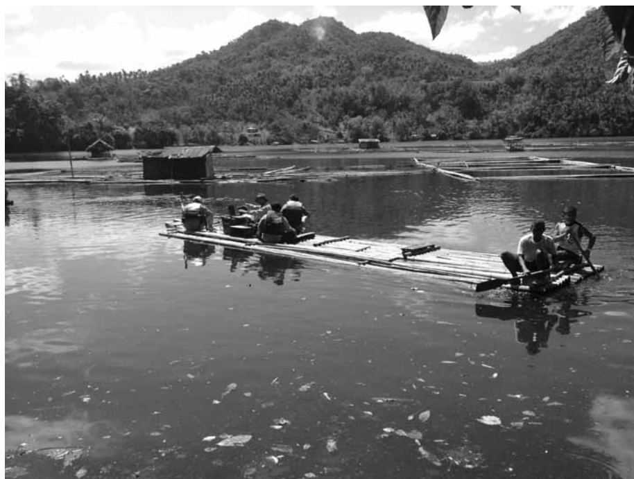
フィリピン、サン・パブロ市付近のマール（爆裂火口湖）での音波探査の調査風景。ティラピア養殖のために現地人が使っているバンブーボート（竹で作られた簡易筏）に各種装置を艀装しての探査。（2014年2月、撮影者：山田和芳）
