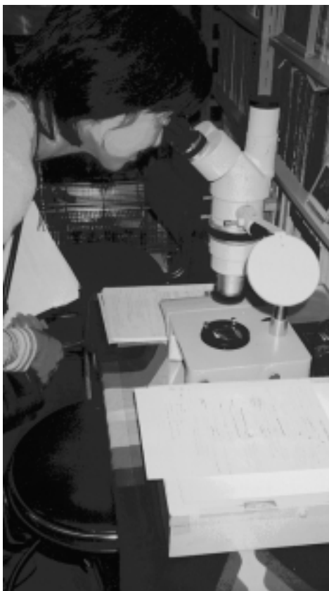
写真4：描画装置付き実体顕微鏡による観察
