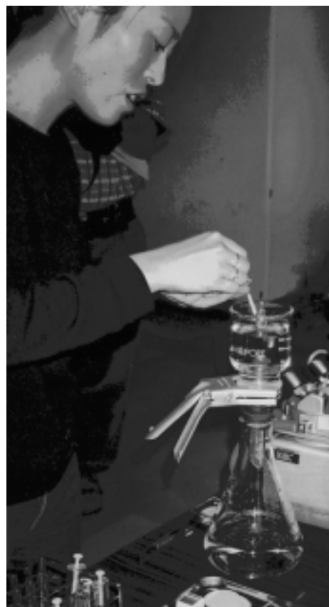
写真5：珪藻分析(吸引濾過による方法)
